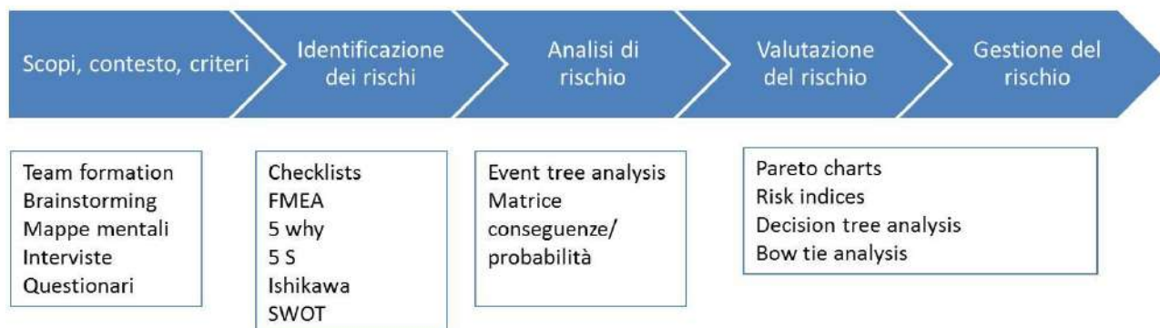
Figura 9. Tappe e strumenti di analisi per la valutazione e la gestione del rischio.
